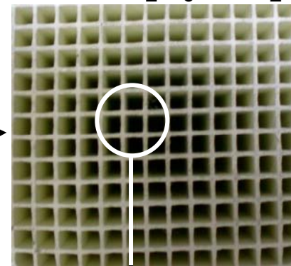
ハニカム触媒 MgO-Al_2O_3-SiO_2
