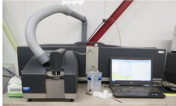
Fig. 9 粒度分布測定機
