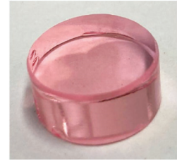
図 1 濃度最適化のために作製した Er/Dy 共添加 ZBLAN バルクガラス
