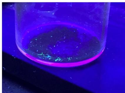
図5  $\kappa$ -カラギーナン, 10-CDPA, 11-AUPA 及び量子ドットを固定化した試料にブラックライトを照射した様子。
