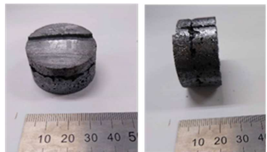
図8 育成した1.5インチ径 Sn/SnSe 共晶体構造バルク結晶。
