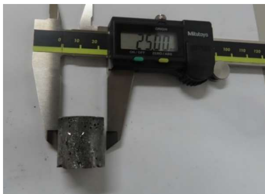
図 3 育成した 1 インチ径 SnSe/SnSe 2 共晶体構造バルク結晶。
